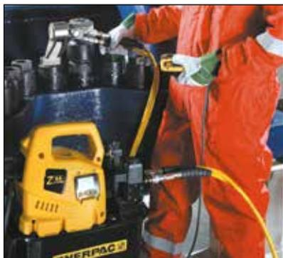
◀ Переносные насосы серии ZU4T могут быть использованы для подачи давления на гидравлические моментные ключи любой модели.
